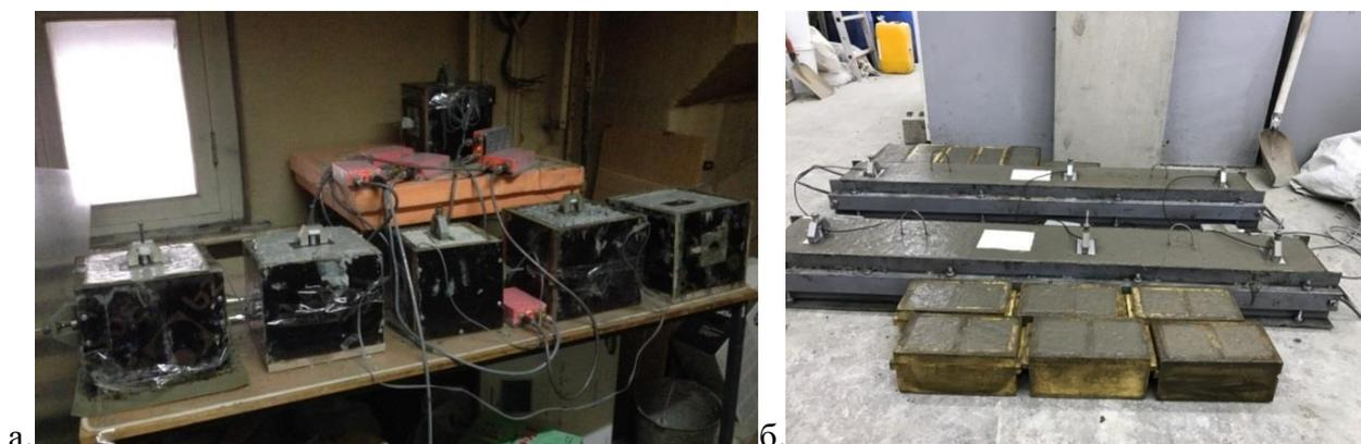
Рисунок 1 – Пример проведения эксперимента по твердению (а) бетонных кубических образцов, (б) ЖБ балок
