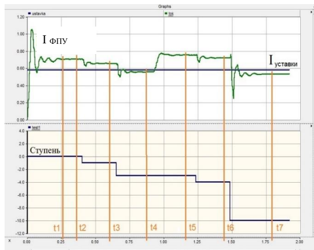
Рис. 11. Диаграммы тока в фазе А сети с установленным ФПУ, номера ступеней ФПУ
