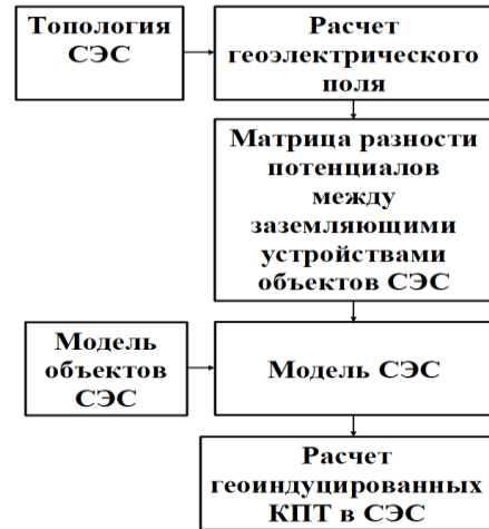
Рис. 2 – Алгоритм моделирования геоицированных КПТ в СЭС
