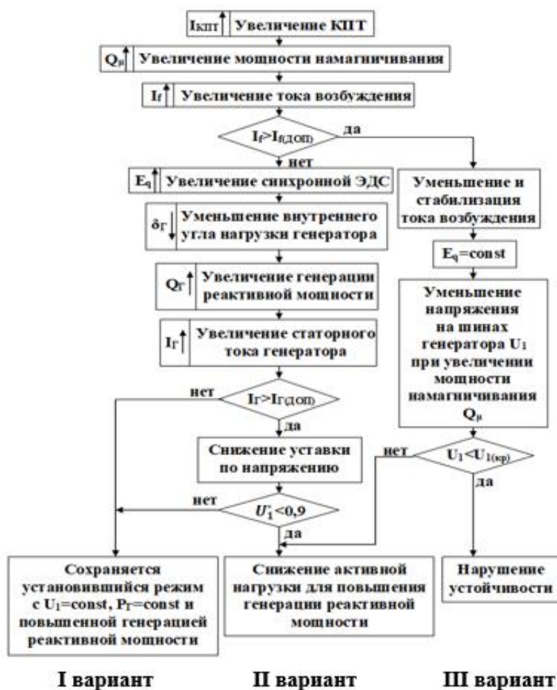
Рис. 8 – Блок-схема обобщенного сценария реакции блока «генератор-трансформатор» на увеличение геоиндуцированных КПТ
