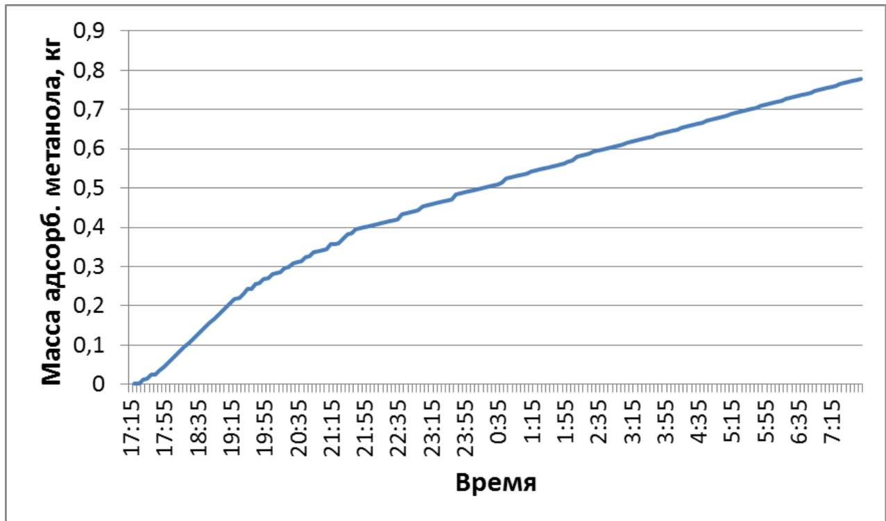
Рисунок 2.28. Расчетное количество адсорбированного метанола, цикл 14/02/2011, Доминикана
