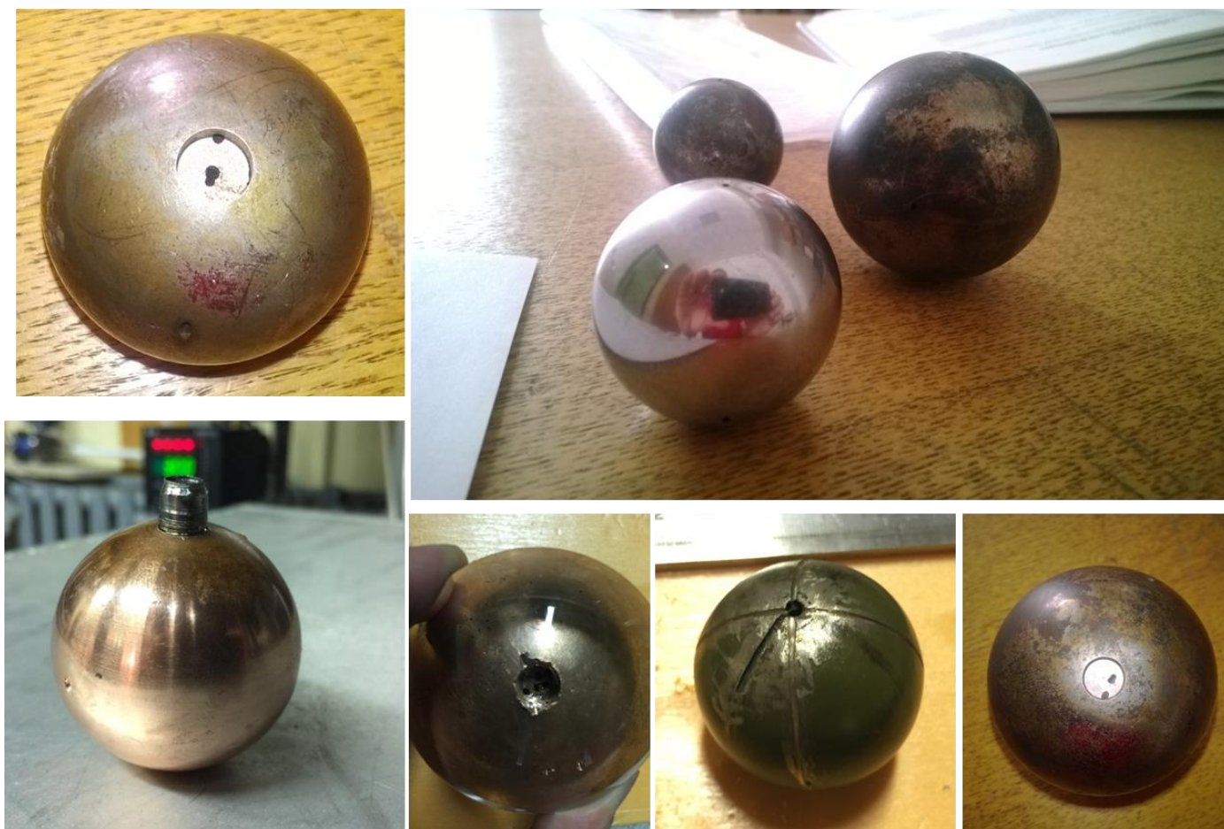
Рис.2.9. Шары с отверстиями под термопары.
