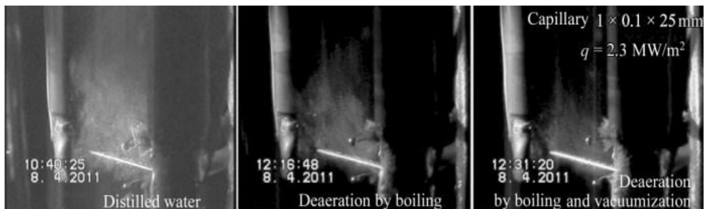
Рис.1.35. Фотокадры кипения воды разной степени дегазации.
