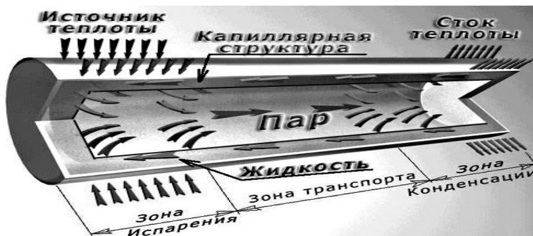
Рис.1.14. Принцип работы радиатора типа «тепловая труба»
