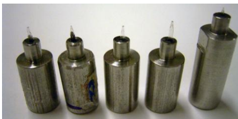
Рис. 5.9. Внешний вид и отдельные элементы генератора монодисперсных капель для установок по получению криогенных корпускулярных мишеней
