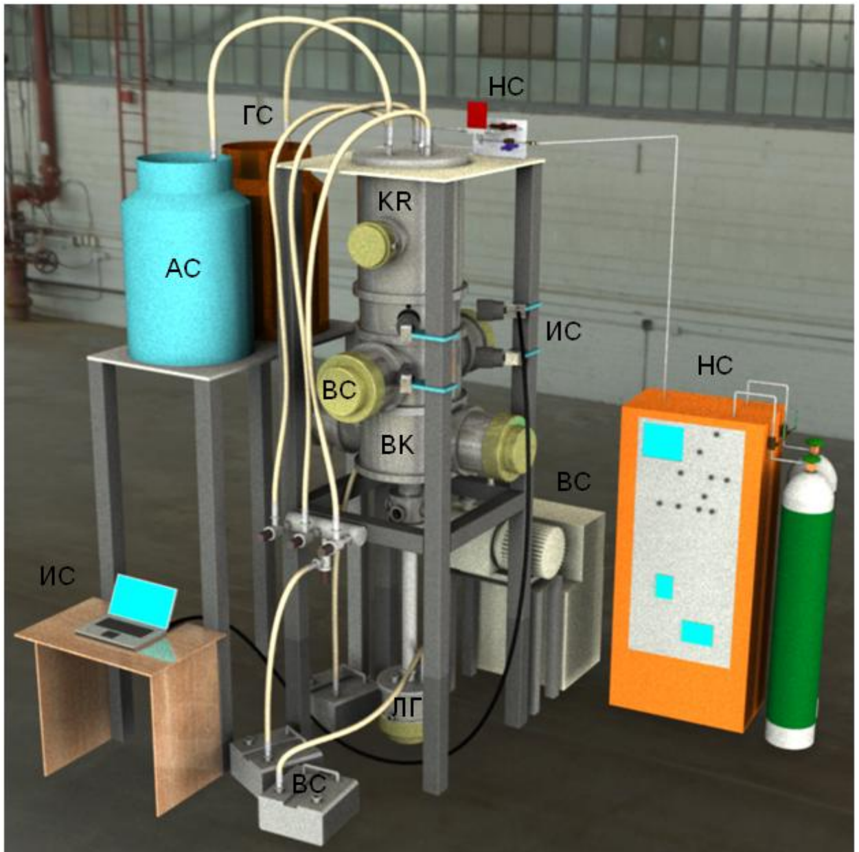
Рис. 5.3. Расположение отдельных систем установки: KR – криостат, BK – вакуумные пролётные камеры, ЛГ – ловушка гранул, BC – вакуумная система, HC – система подачи охлаждаемого вещества, GC – система обеспечения жидким криоагентом внутренней ванны, AC – система обеспечения жидким криоагентом внешней ванны, IS – измерительная система
