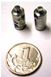
Рис. 5.10. Насадки, изготовленные по двухкомпонентной технологии: а – внешний вид насадок; в – увеличенная выходная часть насадки D_N=7 мкм; с – увеличенная выходная часть насадки D_N=15 мкм
