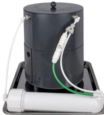
Рисунок 4.5. Установка химической очистки пробных фильтрующих модулей
