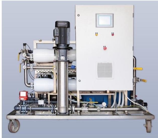
Рисунок 3.2. Фото экспериментальной установки для тестирования обратноосмотических мембран 8”
