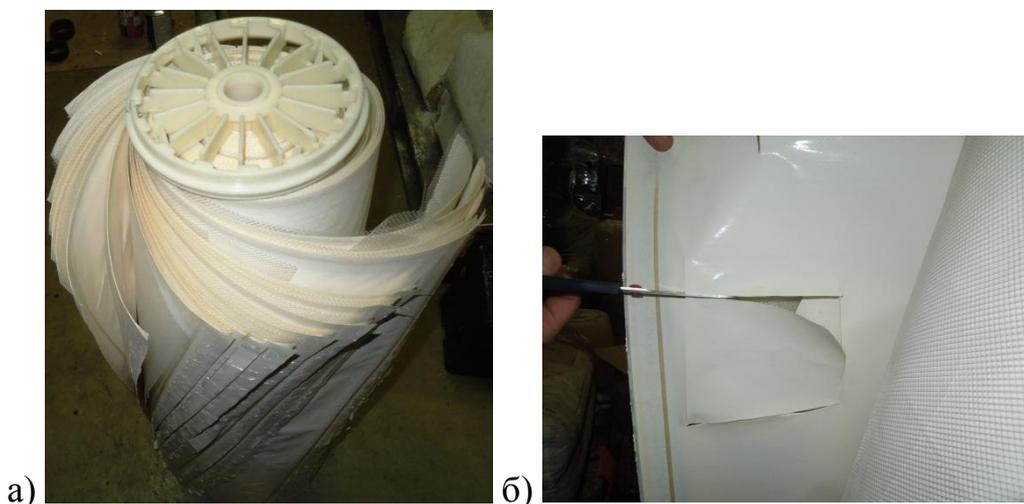
Рисунок 4.2: а) – разобранный обратноосмотический мембранный элемент, б) – процедура вырезания мембранного селективного слоя
