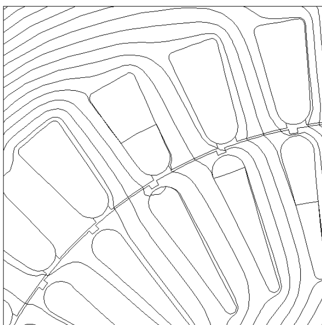
Рисунок 2.18 - Увеличенный фрагмент магнитных силовых линий в номинальном режиме
