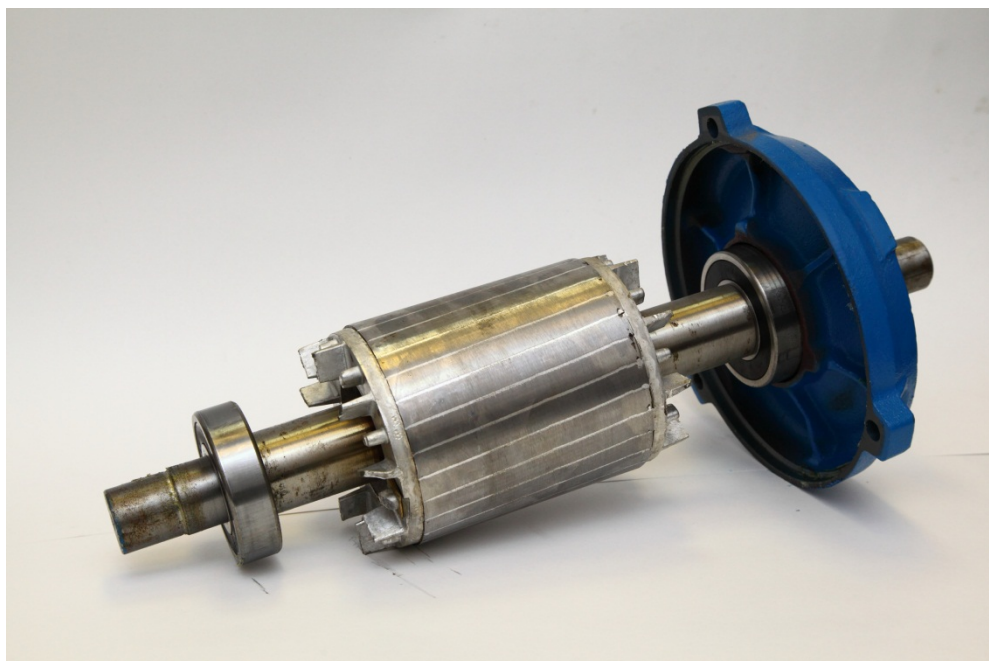
Рисунок 1.1 - Ротор в сборе асинхронного электродвигателя 5А
