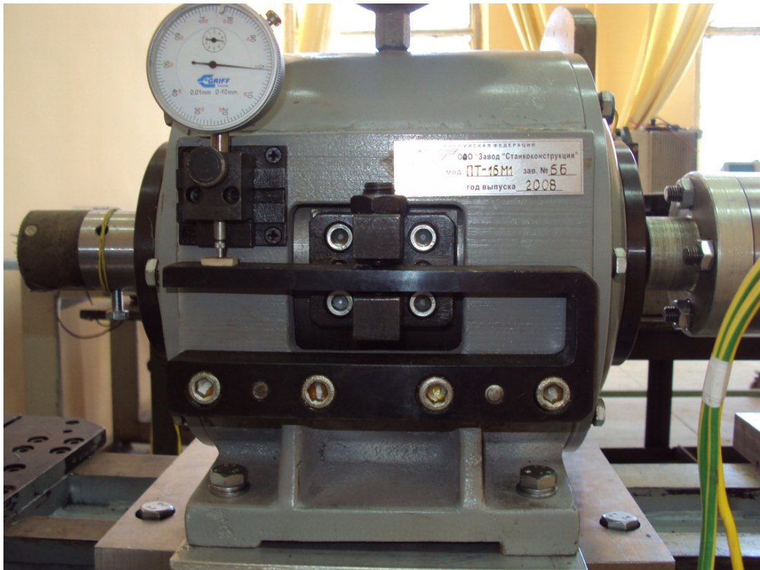
Рисунок 5.2 - Порошковый тормоз ПТ-16М1
