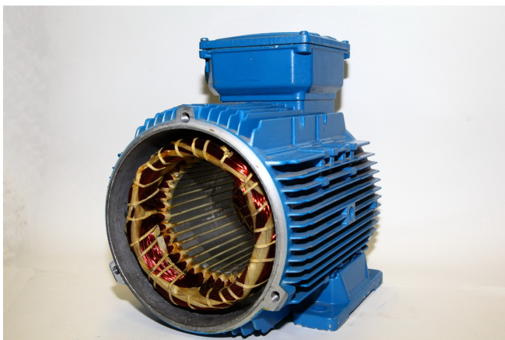
Рисунок 1.2 - Статор асинхронного электродвигателя 5А
