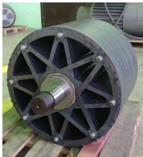
Рис. 8.19. Статор и ротор (магниты не установлены) СДПМ1
