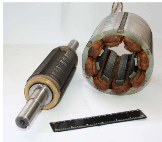
Рис. 8.8. Чертеж общего вида и фотография активной части электродвигателя ВИД80-2Н-2.2
