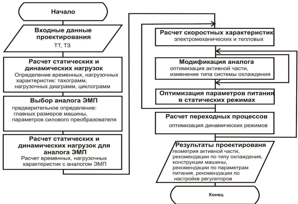
Рис. 2.1. Алгоритм проектирования мехатронной системы на основе энергетического расчета
