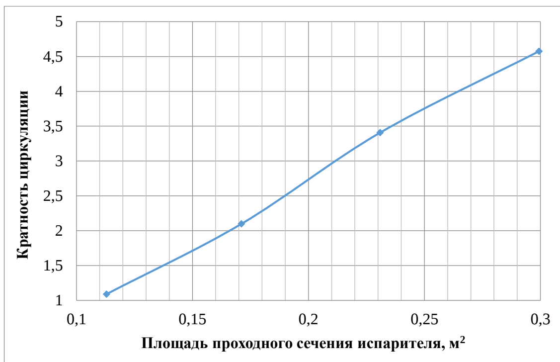
Рисунок 3.11 – Зависимость кратности циркуляции от площади проходного сечения испарителя
