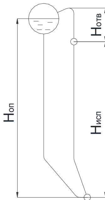
Рисунок 3.1 – Схема контура циркуляции с вертикальным расположением труб испарителя
