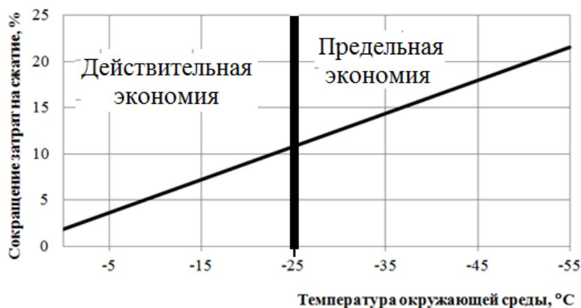
Рисунок 2.9 – Расчетная зависимость экономии энергии в процентах от затрат на сжатие от температуры окружающей среды
