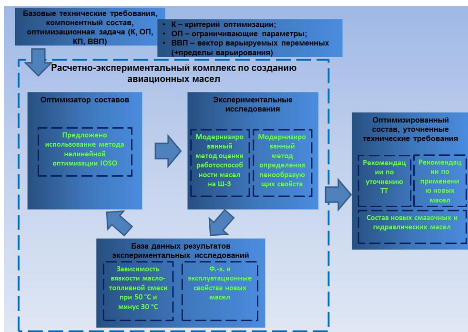
Рисунок 2.1 – Структурная схема расчетно-экспериментального комплекса методов по созданию авиационных масел
