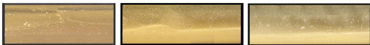
Рисунок 2.18 – Изменение цвета масловоздушной смеси при включении/отключении насосов ДЭСС: 1 – после включения насоса, 2 – 30 сек после включения насоса; 3 – после отключения насоса
