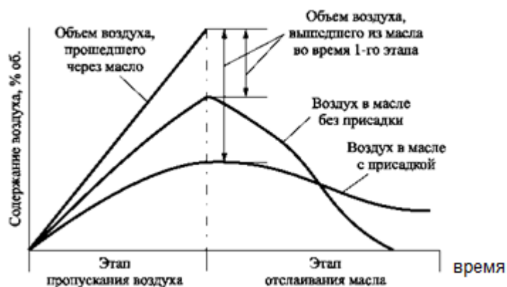
Рисунок 3.5. Изменение содержания воздуха в маслах по времени при добавлении кремнийорганической присадки
