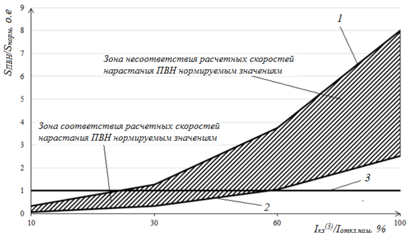
Рисунок 4.9. Зависимости отношений расчётных скоростей нарастания ПВН к нормированным значениям от отношений I_{кз}^{(3)}/I_{откл.ном} :
