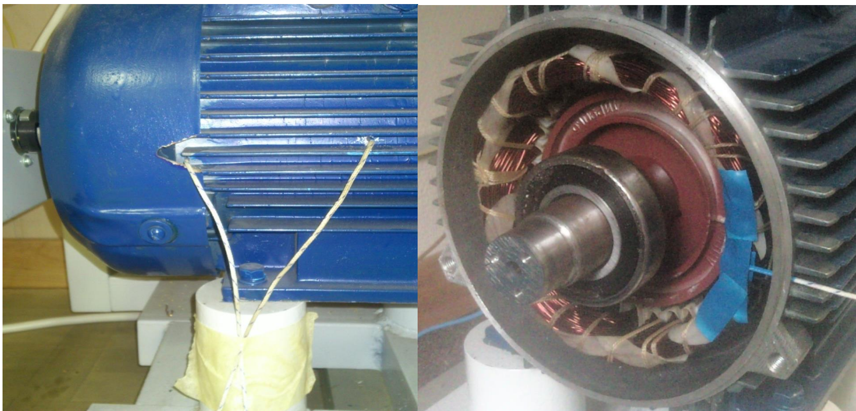
Рис.3.4 – Расположение термопары в корпусе двигателя
