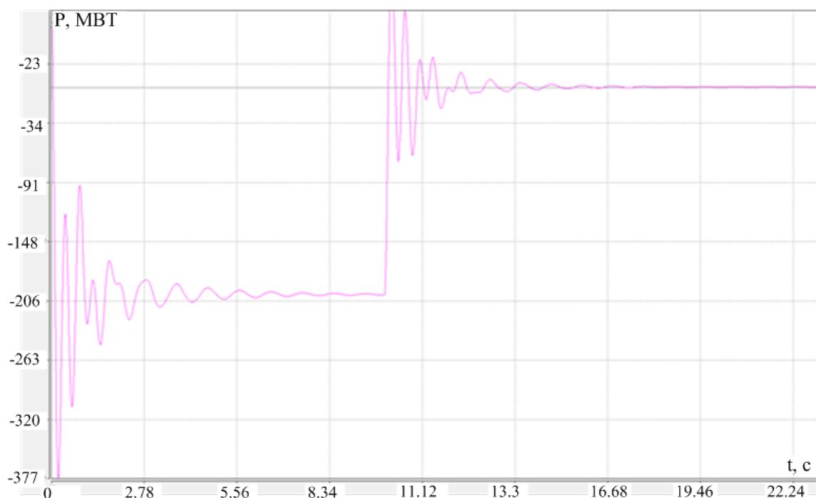
Рис. 4.3 Переходный процесс ( $P_{23}$ ) при увеличении нагрузки узла 3 на 200 МВт в тестовой схеме рис. 3.18
