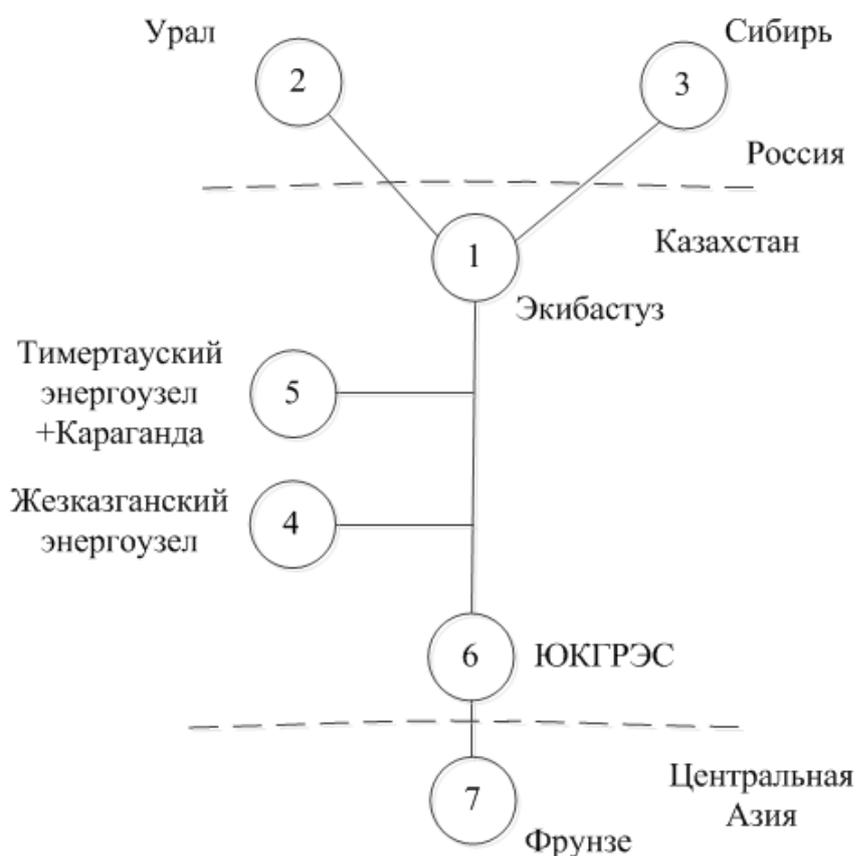
Рис. 2.14 Упрощенная схема замещения энергосистемы Казахстана
