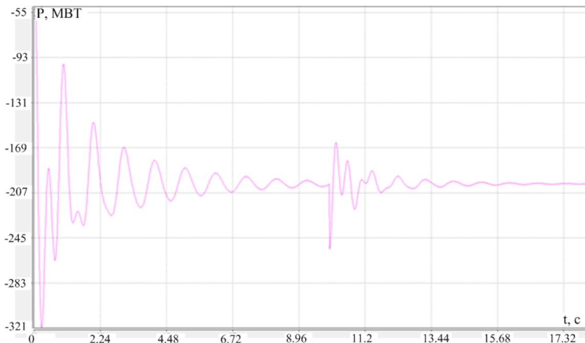
Рис. 4.2 Переходный процесс ( $P_{23}$ ) при отключении связи  $L_{24}$  в тестовой схеме рис. 3.18
