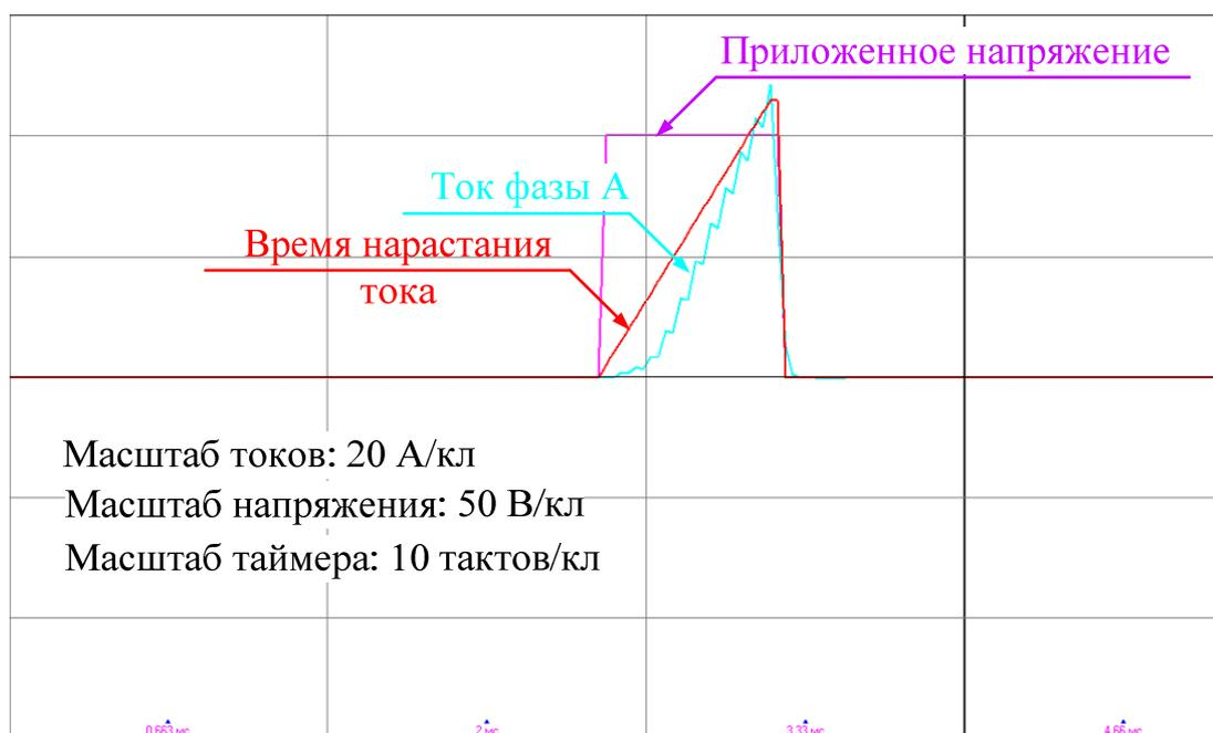
Рис. 5.34. Процедура измерения индуктивности для настройки регулятора тока
