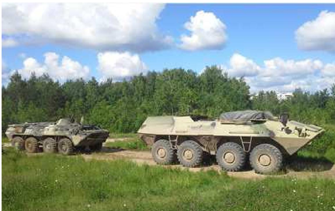
На взлетной полосе Кубинского аэродрома, 22-тонный макетный образец разогнался до скорости 80 км/час за 33 секунды. Максимальная скорость, составила 97 км/час.
