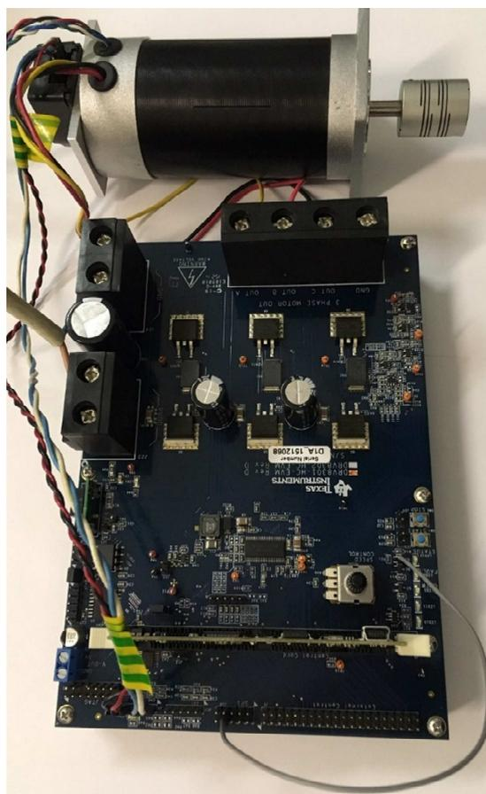
Рис. 3.12. Экспериментальная установка с СДПМ
