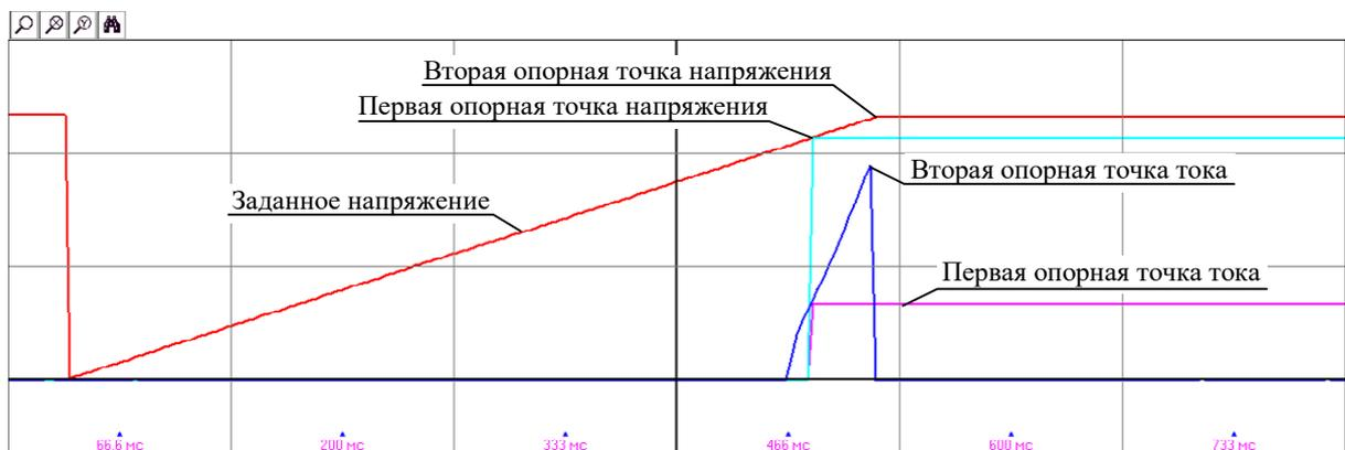
Рис. 5.33. Процедура измерения сопротивления статорной цепи для настройки регулятора тока
