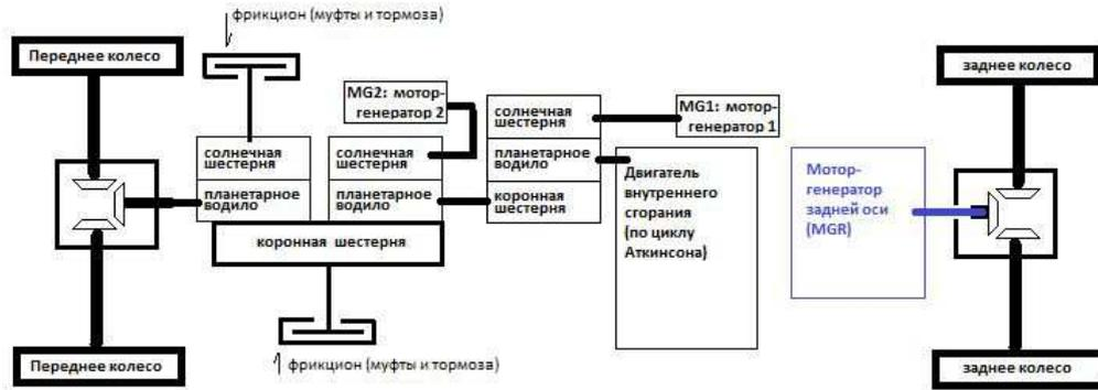
Рис. В7. Схема трансмиссии Lexus GS 450h и Lexus LS 600h (рисунок с сайта <http://vodorod-tex.ru/statia/hybrid-synergy-drive.html>).
