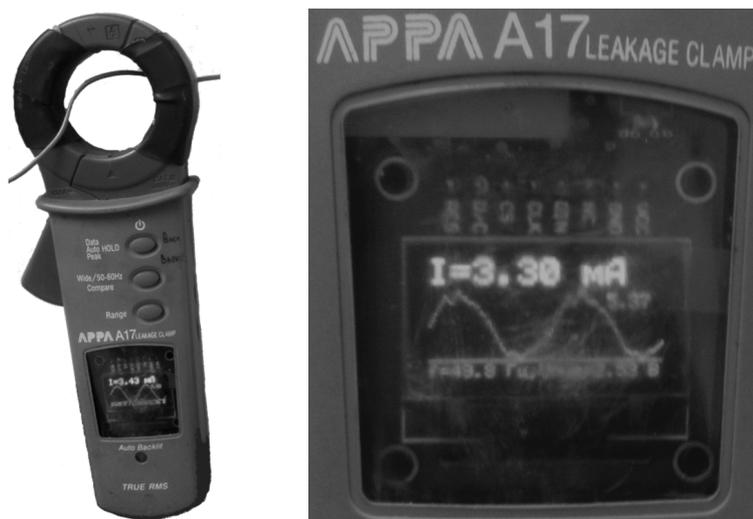
Рис. 5.25. Внешний вид и дисплей модифицированных токоизмерительных клещей
