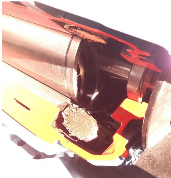
Рис. 1.18. Разрез синхронной реактивной машины компании АВВ. Фотография сделана на стенде компании на конференции ЕРЕ-2014 в Техническом университете Лаппеенранты в Финляндии
