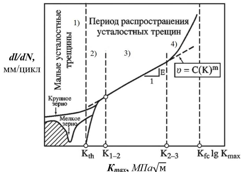
Рисунок 1.2 – Кинетическая диаграмма усталостного разрушения [24]
