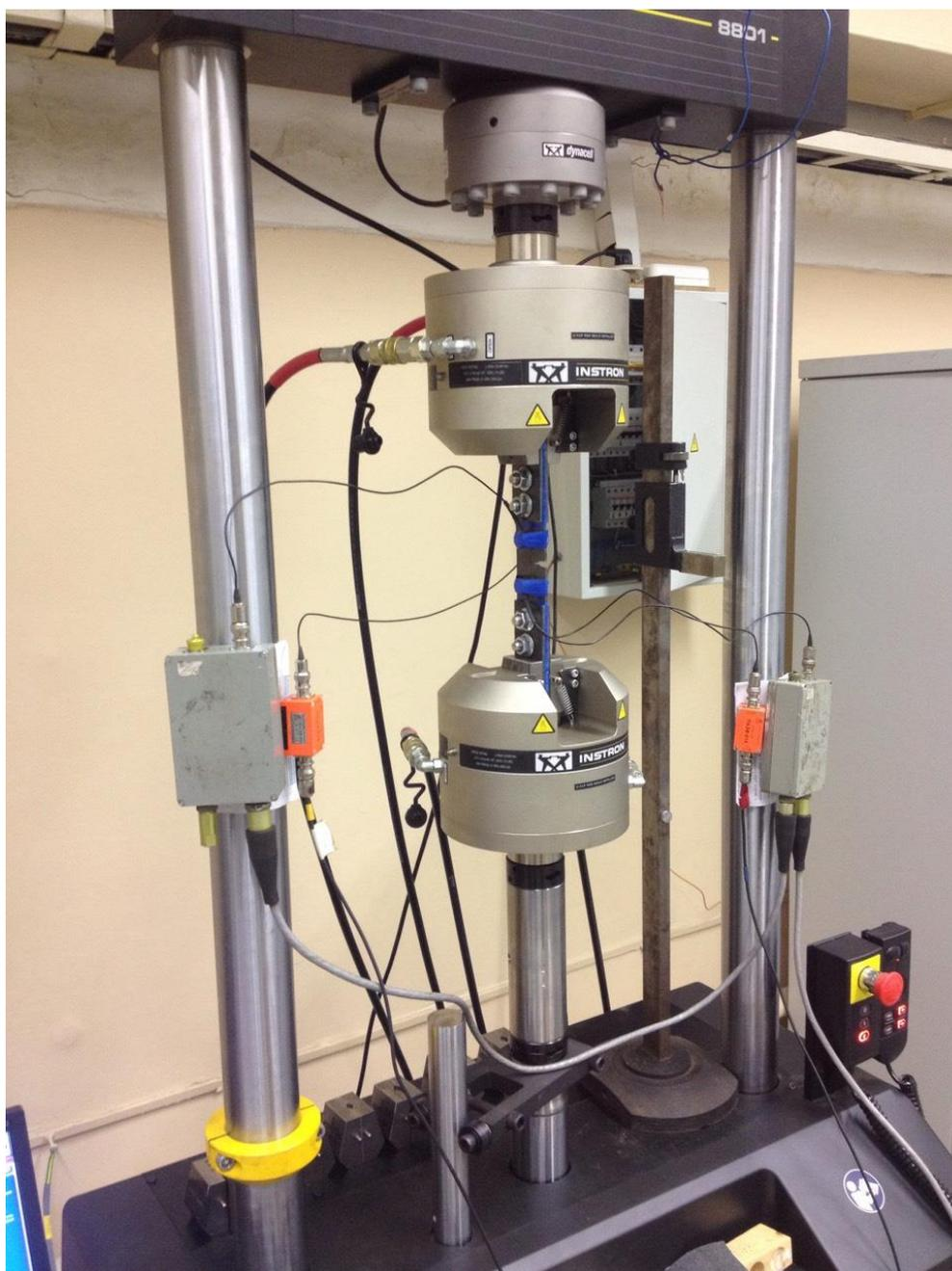
Рисунок 2.3 – Общий вид испытательной машины INSTRON 8801 при циклическом нагружении образца с применением метода АЭ
