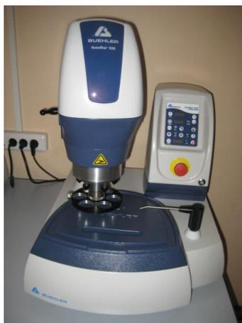
Рисунок 2.15 – Отрезной станок Buehler AbrasiMatic 300 (а), автоматический станок для горячей запрессовки Buehler SimpliMet 1000 (б) и шлифовально-полировальный станок Buehler EcoMet 250 (в)
