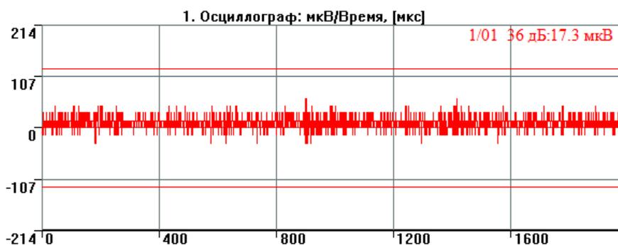
Рисунок 2.6 – Пример шумового сигнала АЭ, зарегистрированного при установке образца в захваты нагружающей машины
