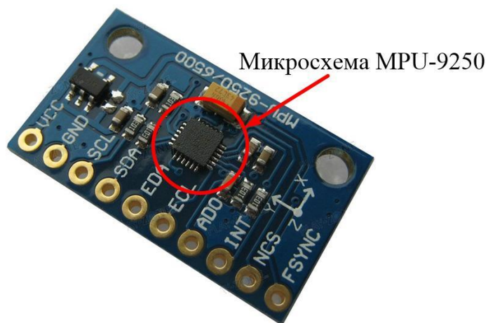
Рис. 3.1. Внешний вид печатной платы модуля GY-9250
