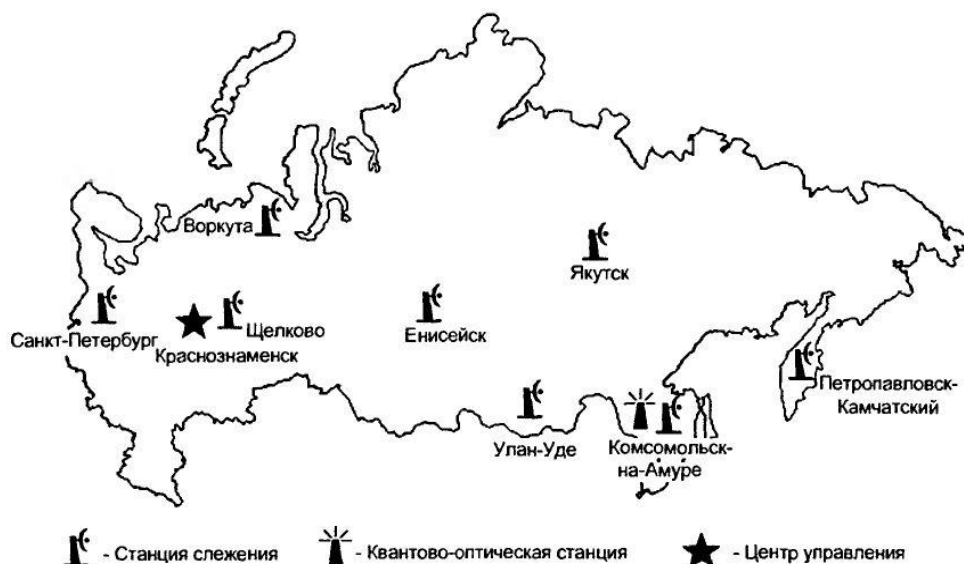
Рис.2.8. Расположение станций сегмента управления ГЛОНАСС
