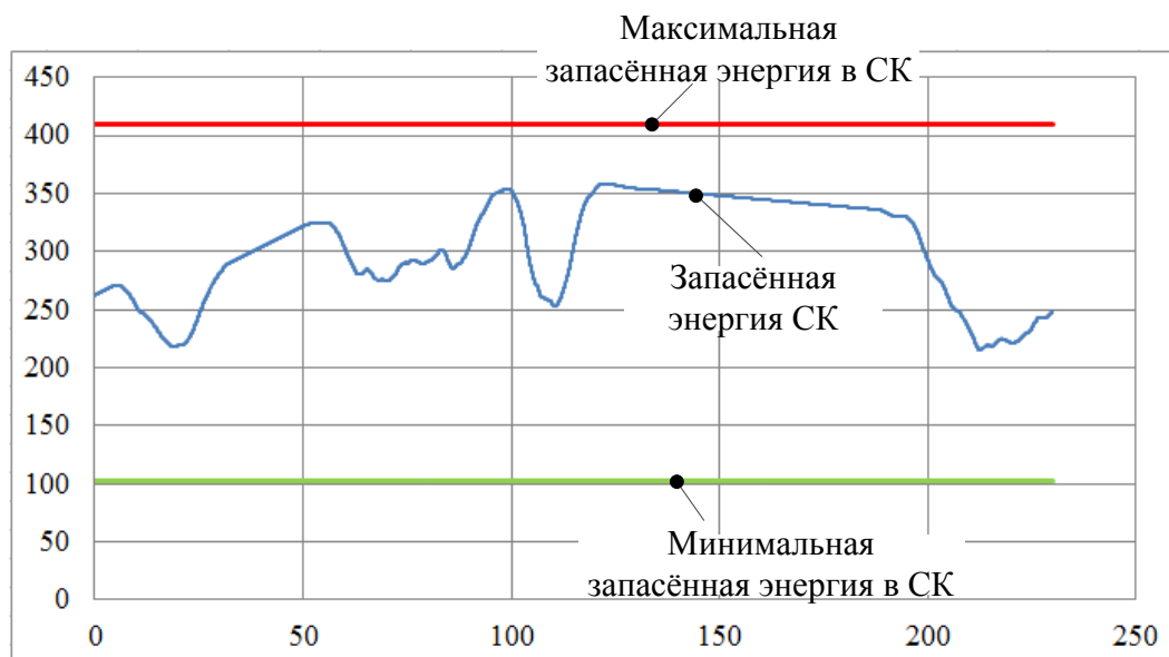
Рис. 5.12. Запасаемая энергия в блоке суперконденсаторов модуля BMOD0063-P125-B08
