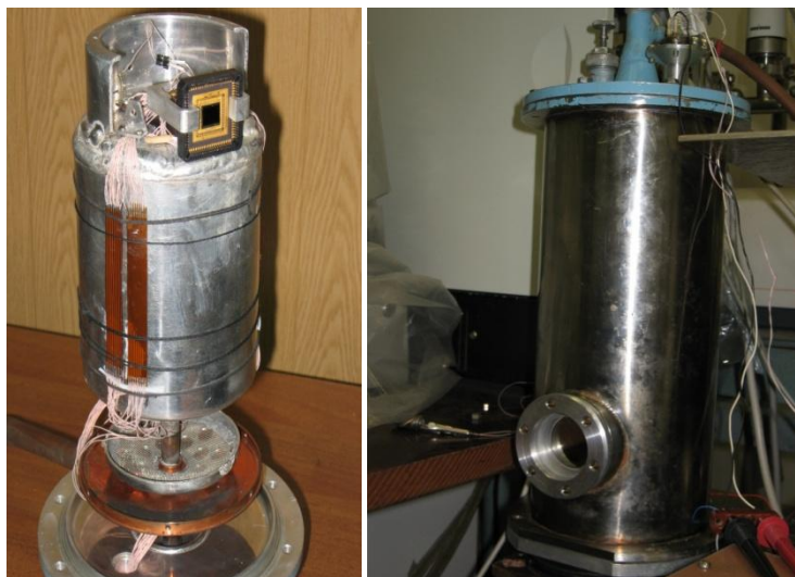
Рис. 4.3. ГФС в заливном криостате а) и заливной криостат в сборе б).
