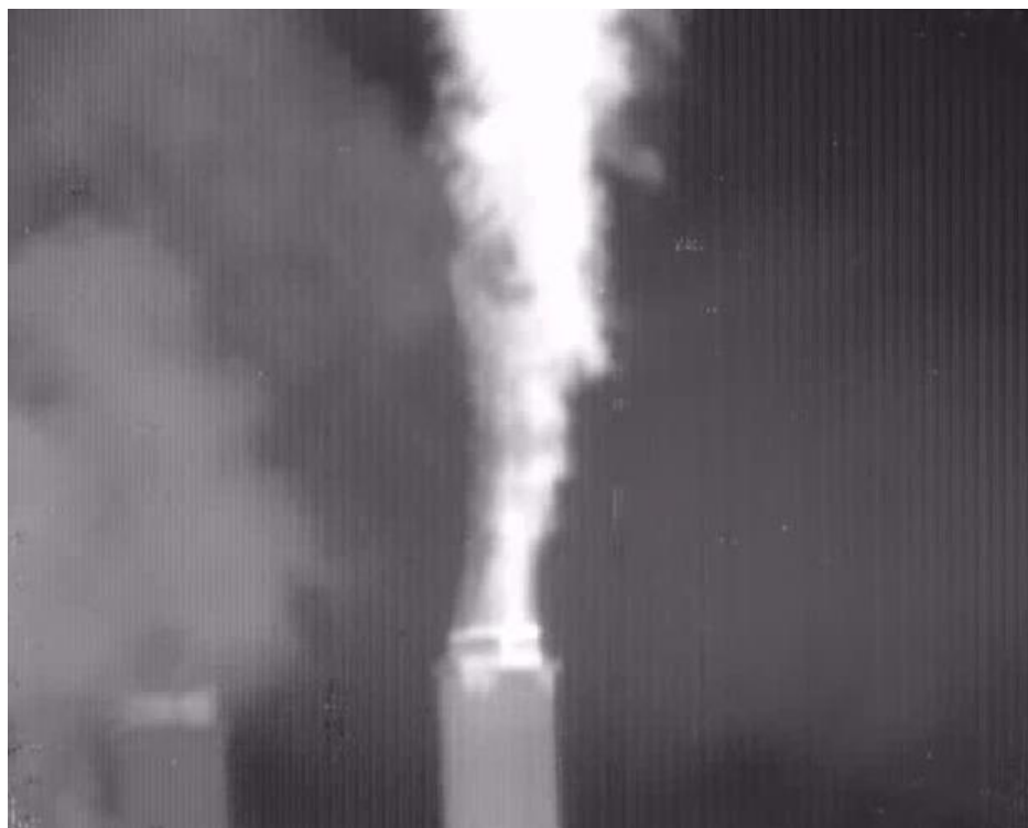
Рис. 5.27 – Тепловизионное изображение труб ТЭЦ, Сформированное ТВП в узком поле зрения
