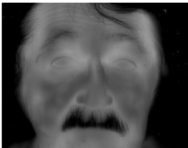
Рис.5.21. Изображение, полученное с помощью СКЯ ФПУ формата 640x512 элементов при использовании цифровой коррекции.
