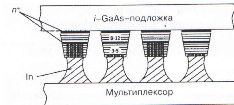
Рис.3.22.Схематическое изображение двухспектральной ГФС с ЧЭ чересстрочной конструкции.
