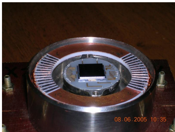
Рис. 3.27. ГФС в корпусе - криостате макета ФПУ
