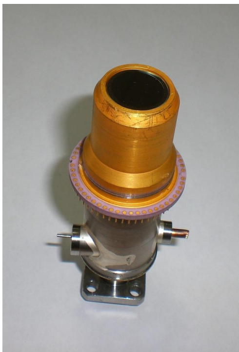
Рис.5.15 ФПУ с приваренной крышкой после вакуумирования
