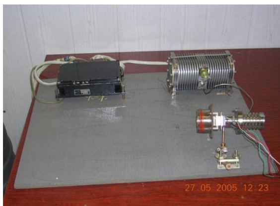
Рис.5.4. Изображение испытательного стенда с МКС МСМГ-5А-1,3/80.
