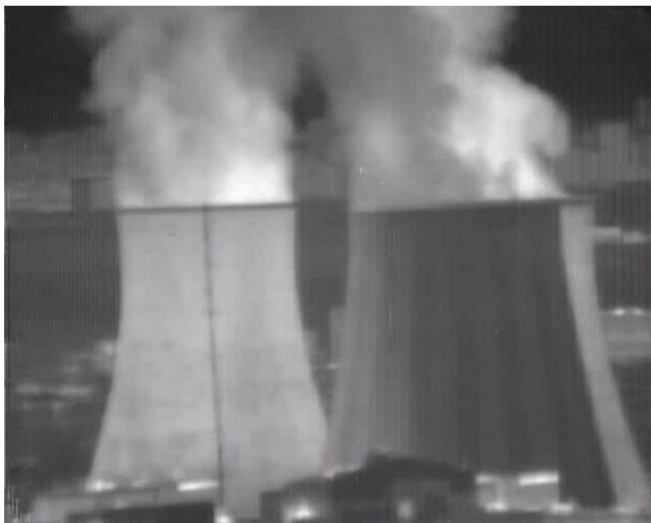
Рис. 5.25 – Тепловизионное изображение труб ТЭЦ, сформированное ТВП в узком поле зрения
