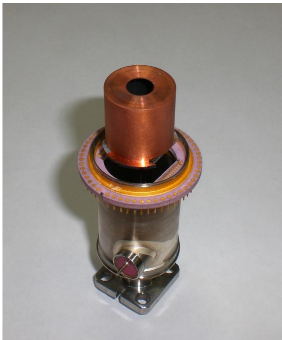
Рис.5.14 ФПУ с приклеенной диафрагмой.
