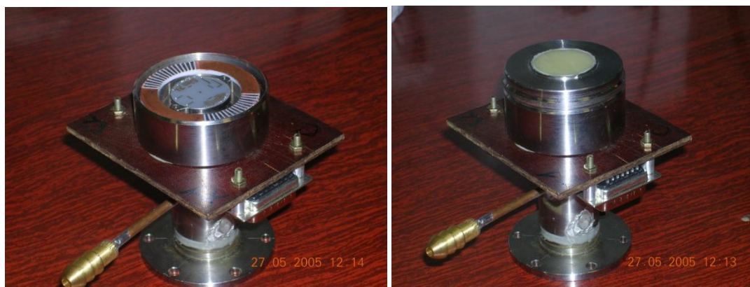
Рис.5.3. Внешний вид макета корпуса криостата : а) без крышки; б) с крышкой с входным окном.
