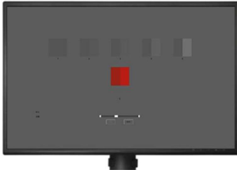
Рисунок 1.8 – Дисплей, показывающий 5-ступенчатую шкалу серого (вверху), пару цветовых различий (в центре) и ползунок, позволяющий наблюдателю записать разницу в цветах (внизу)
