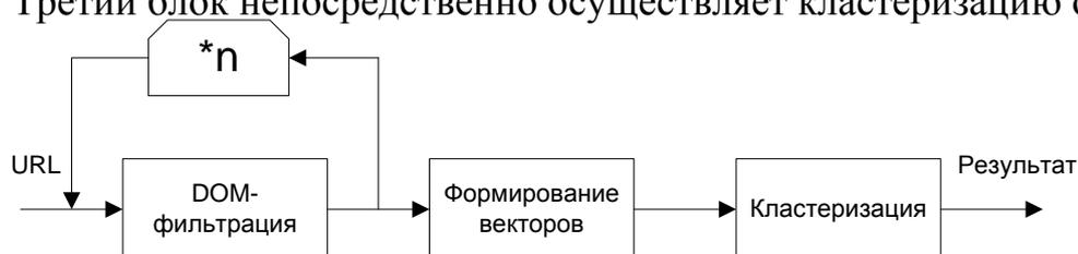
Рисунок 3.11 – Схема трехтактной кластеризации динамических ИР
