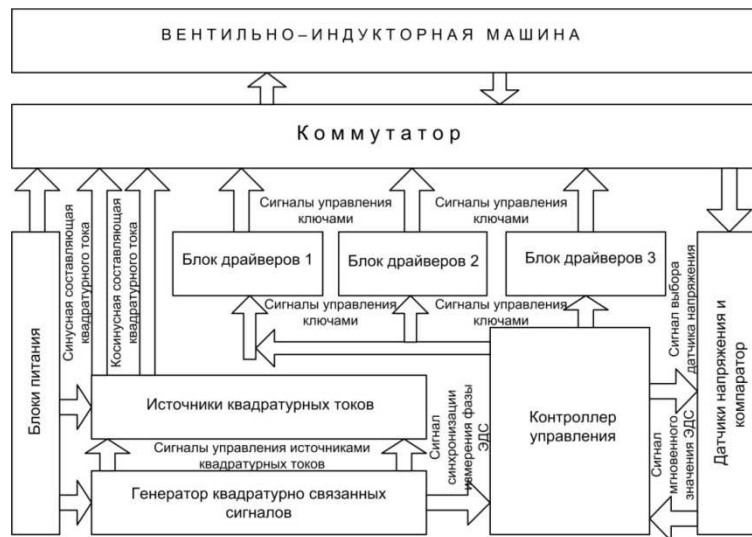
Рис. 3.2. Функциональная схема взаимодействия аппаратных частей микропроцессорной системы управления бездатчикового ВИП.
