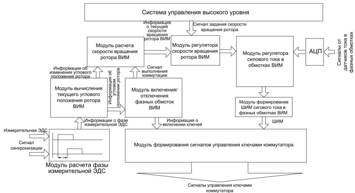
Рис. 3.3. Функциональная схема взаимодействия программно аппаратных средств контроллера управления.
