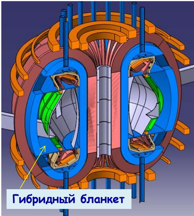
**Токамак позволяет создать стационарный источник нейтронов с интенсивностью  $10^{16}$ - $10^{20}$  н/с**
