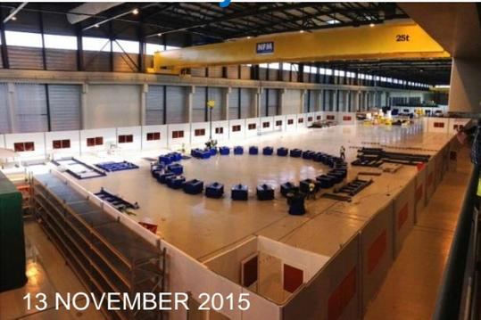
Два стола для намотки сдвоенного витка "double pancakes" на площадке ИТЭР
