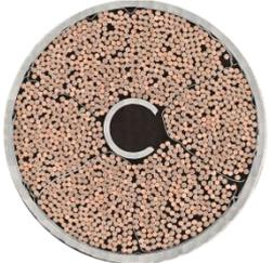
Сверхпроводник тороидального поля содержащий 900  $Nb_3Sn$  стрендов и 522 медных стрендов
