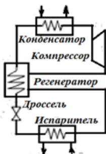
Рис.1. Принципиальная схема ТНУ с регенератором
