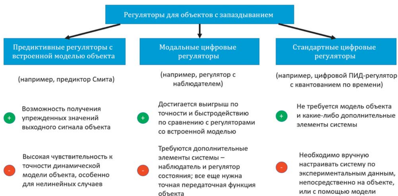
Рис. 4. Сравнение различных типов регуляторов для управления объектами с запаздыванием
