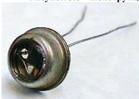
**Рисунок 3.9 – Конструкция фоторезистора типа ФР202**
