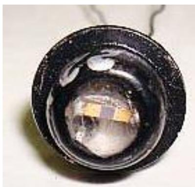
**Рисунок 3.10 – Конструкция фоторезистора типа ФС-3 АН**
