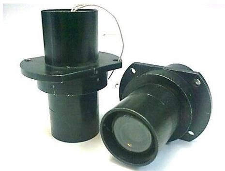
Рисунок 3.2. – Вакуумный ФСВ-12А
