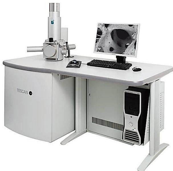
Рисунок 2.12 – Растровый электронный микроскоп VEGA11SBU
