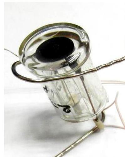
**Рисунок 3.12 - Сосуд Дьюара с ФЧЭ вакуумного фоторезистора [170]**
