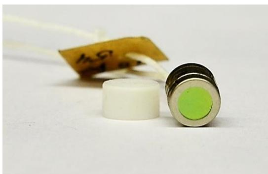
Рисунок 3.4 – Конструкция фоторезистора ФС-2АН, физический
