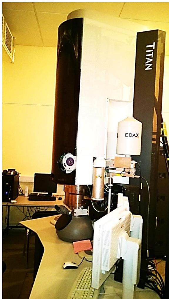
**Рисунок 2.15 – Внешний вид прибора S/TEM Titan 80-300 (FEI, США)**
