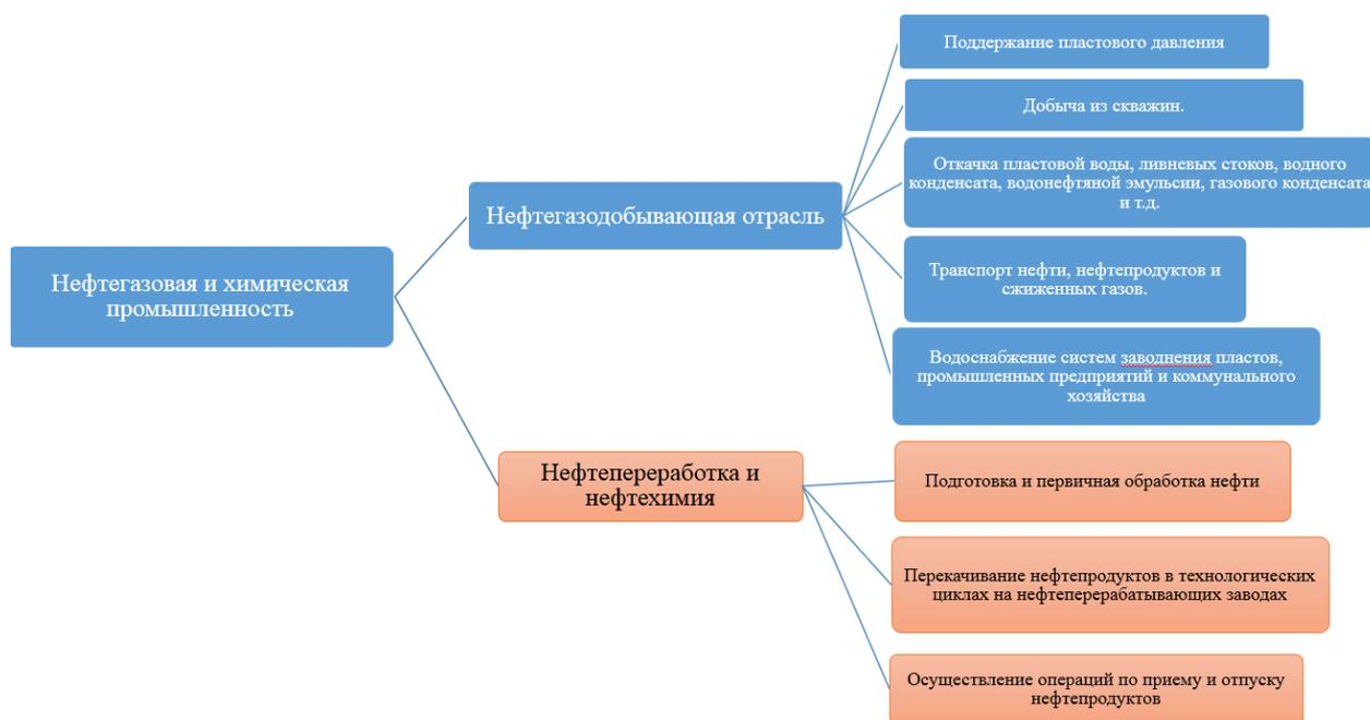
Рисунок 1 – Области применения центробежных насосов в нефтегазовой и химической отрасли
