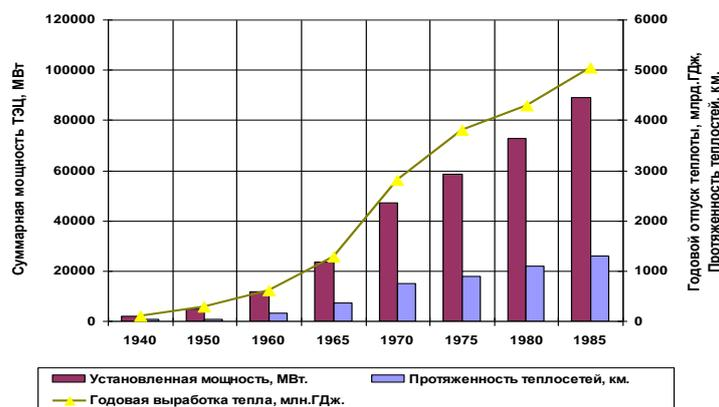
Рис. 5. Динамика основных параметров теплофикационных систем
