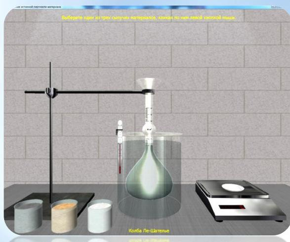
Целью имитационного опыта является определение величины истинной плотности порошкового материала с помощью специальной стеклянной колбы – объёмомера Ле-Шателье. Входными параметрами имитационного опыта являются: тип строительного материала (цемент, песок, гипс) и масса опытной навески (г). Выходными данными служат: масса остатка пробы (г) и объем вытесненной жидкости (мл).
