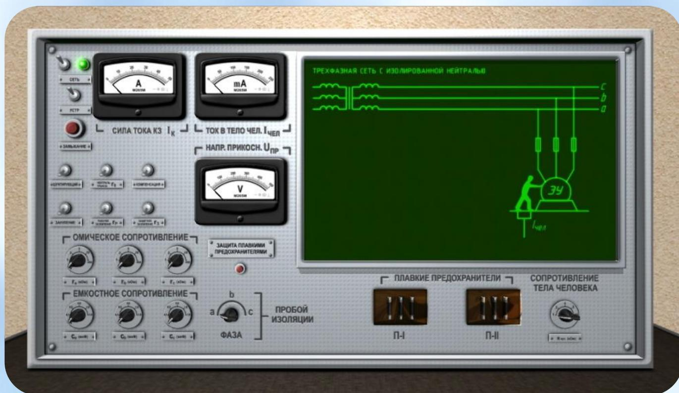
электронный мегаомметр (для измерения сопротивления изоляции фаз кабелей) и электронный измеритель сопротивления заземляющего устройства. Лабораторная работа разделена на 3 учебно-методических части: работа со стендом; измерение сопротивления изоляции фаз кабелей; измерение сопротивления заземляющего устройства.
