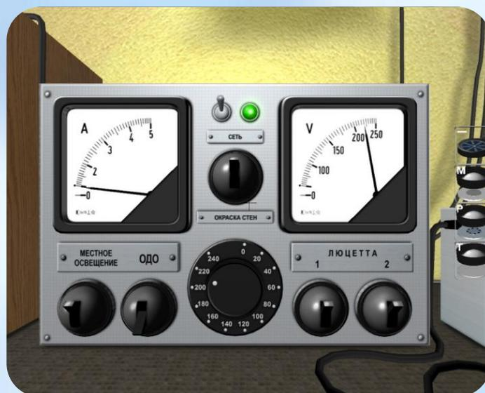
В кабине предусмотрены устройства, позволяющие включать системы общего и комбинированного освещения с люминесцентными лампами и лампами накаливания, изменять с помощью лабораторного автотрансформатора напряжение в электрической сети, а с помощью разноцветных щитов моделировать окраску стен помещения.
