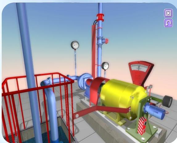
Цель работы заключается в установке не менее 8-10 различных режимов работы насоса с помощью задвижки, открытие которой изменяется от 0 до 100 %; снятия при каждом режиме показаний приборов (манометра, вакуумметра, весов, тахометра и дифференциального манометра); вычисления параметров, необходимых для построения напорной и энергетической характеристик насоса.
