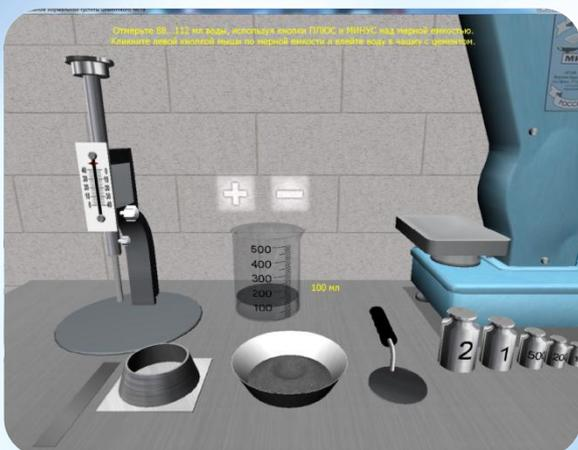
Целью имитационного опыта является определение нормальной густоты цементного теста с помощью прибора Вика. Входными параметрами опыта являются: масса грузов, уравнивающих емкость для перемешивания теста (г) и объем добавляемой в цемент воды (мл). Выходные данные – глубина погружения пестика прибора Вика в цементное тесто (мм).
