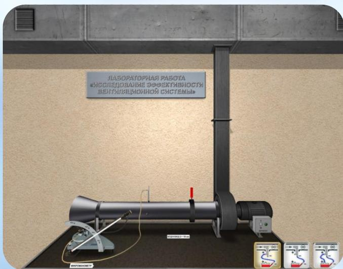
Цель работы заключается в освоении го-тированного метода аэродинамического испытания общеобменной вентиляционной системы и определении ее эффективности. В виртуальной лабораторной работе имитируется специально оборудованный стенд аэродинамического испытания общеобменной вентиляционной системы.
