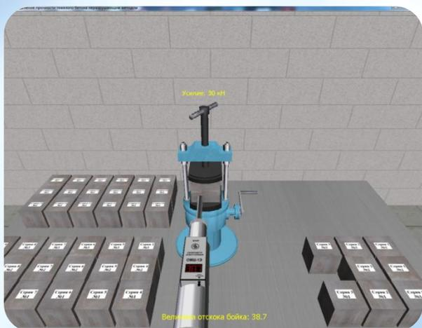
Целью имитационного опыта является определение величины прочности бетона неразрушающим методом с помощью электронного склерометра. Входным параметром имитационного опыта является номер выбранного испытуемого образца-куба бетона. Выходным параметром служит величина отскока бойка склерометра (условная величина).
