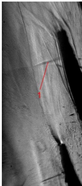
Волновая структура потока на насыщенном паре  $\Delta T = 0^\circ \text{C}$
