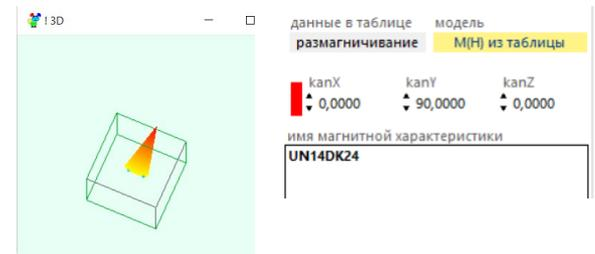
Ось легкого намагничивания для магнитотвердых материалов
